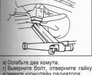
г) Выверните болт, отверните гайку и снимите кронштейн радиатора.
