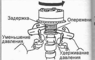
**Примечание:** в результате фиксатор должен освободить механизм установки на угол поворота соответствующий самому позднему началу открытия выпускных клапанов (максимальный угол задержки). В зависимости от подведенного давления, поворот шестерни механизма осуществляется без приложения дополнительных усилий (без подворачивания его рукой) или наоборот, с чрезмерным усилием.
